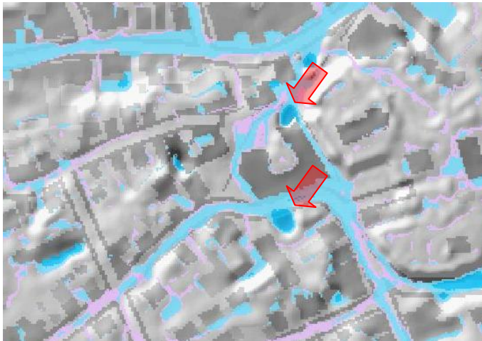
Einfahrten von Tiefgaragen werden in der Simulation geflutet, entsprechende Stellen sind deutlich gefährdet
